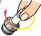
5 そして、プラグレンチで下表に基づく推奨トルク、及び推奨回転角で確実に締めてください。
