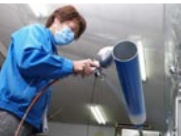
SUBARUメローベに使われる鏡筒には、望遠鏡には珍しいメタリックカラーの専用色「コスミックブルーマイカ」が塗装される。
