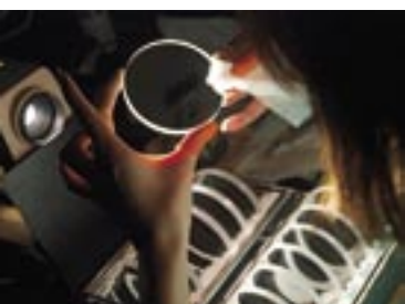
磨き上がったレンズ表面の傷をていねいにチェックする。写真はSUBARUメローベに使用する直径8cmの対物レンズ。
