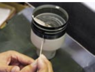
大一光学で行なっている対物レンズの側面をつや消しブラックで塗る「コバ塗り」作業。一本一本ていねいに手で塗られる。
