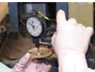
球面計やニュートン原器でチェックを繰り返し、ポリッシング(研磨)すると、曇ったガラス玉が美しいレンズに仕上がっていく。
